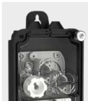
Mosazné lisované svorky a šrouby z nerezové oceli
